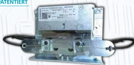
Doppelt wirkende e-ASG UD WRA-Fangvorrichtung mit Doppelspulen-Magnet und Fernauslösung. Ein einziges Magnet zur Auslösung der 4 Verteilungsrollen
